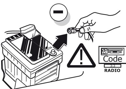
**(DE)** Um Störungen und Schäden am Bordnetz zu vermeiden, muss die Massenpolklemme unbedingt vor Beginn aller Arbeiten von der Fahrzeughauptbatterie getrennt werden! Insbesondere bei Arbeiten und Anschlüssen am CAN-Datenbus kann bei nicht abgeklemmter Batterie sowohl das Anhängermodul als auch das fahrzeugseitige Bordnetzsteuergerät beschädigt werden! Bitte Herstellervorschriften beim Ab- und Anklemmen der Fahrzeughauptbatterie beachten!
